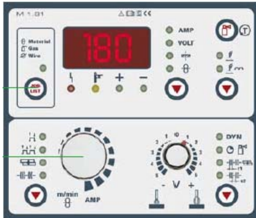
Abb. 2: Intuitive Steuerung mit der Synergic-Einknopfbedienung
