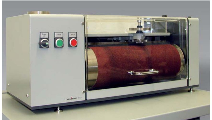
Abrasion tester Zwick 6103
