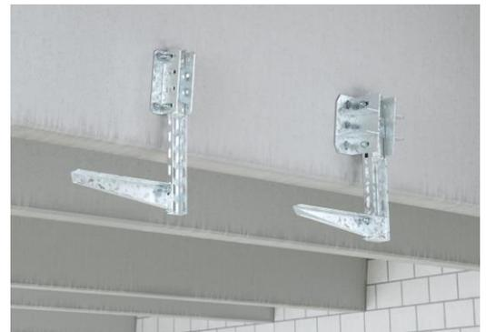
Am U-Stiel wird beidseitig jeweils ein Befestigungswinkel mit Sechskantschrauben, Unterlegscheiben und Muttern befestigt. Das Befestigungsmaterial ist im Lieferumfang enthalten. Geeignet ist der Befestigungswinkel sowohl für vertikale als auch horizontale Installationen. Gefertigt ist der neue Winkel aus tauchfeuerverzinktem Stahl.
