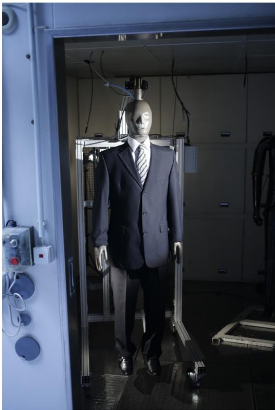
Mit "Sherlock" lassen sich die Wärmeisolation und die Atmungsaktivität von konfektionierten Textilien mit einem Prüfsystem ermitteln. © Hohenstein Group
