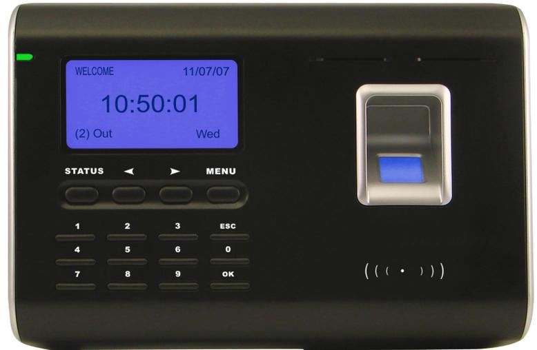
**Zeiterfassungsterminal Premium mit Fingerprint- und RFID-Identifikation.** Mit einer Standard Ethernet-Schnittstelle (TCP/IP), einem optischen Fingerprint-Sensor mit 360° Scanbereich und einem integrierten RFID-Kartenleser, erfüllt das FlexTime Premium sämtliche Benutzeranforderungen.
