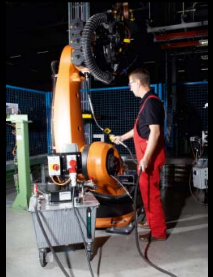
» Für das Entleeren und Befüllen der Getriebe wurden spezielle Aggregate konstruiert. » Special units were built for draining and filling the gearboxes.
