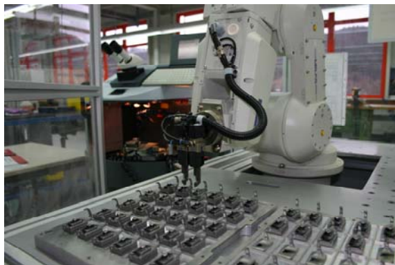
Abb.3: Gerüstet für die mannlose Nachtschicht: Ein Roboter macht die Laseranlage zur autonomen Fertigungszelle
