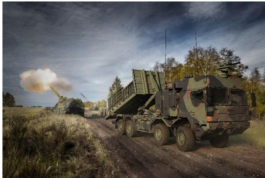
die Bundeswehr-Fahrzeugflotte der militärischen HX-Familie. Die Kernausrüstung der WLS ist das von der Firma Hiab entwickelte Hakenladegerät. Damit lassen sich die in die Bundeswehr eingeführten Wechselladerpritschen ohne weitere Umschlagmittel in nahezu jedem Gelände aufnehmen und absetzen. Alternativ können die Fahrzeuge auch eine Wechselladerpritsche oder einen Container über die standardisierten 20 Fuß ISO-Schnittstellen transportieren.
