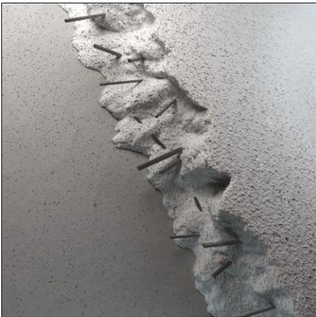
Hightech an der Hauswand: Carbonfasern im Spachtel eines Caparol-Dämmsystems machen die Fassadenoberfläche elastisch und damit stabil gegen äußere Belastungen.
