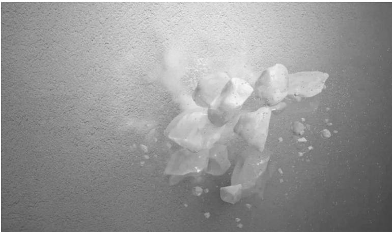
Keine Chance für Hagelschäden: Carbonfaserverstärkte Wärmedämmungen machen Häuser hagelsicher.
