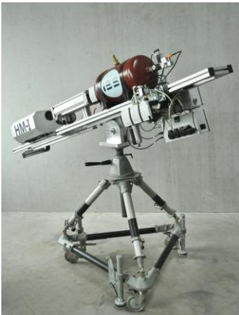
Simuliert den Einschlag von Hagel auf Hausfassaden: Die Hagelschussmaschine des IBS aus Linz.
