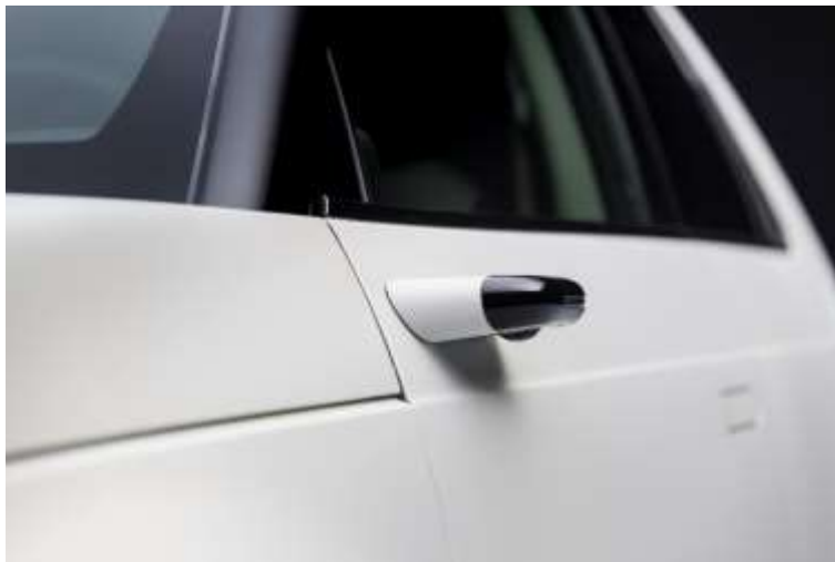
Honda e: Kamerasystem statt Außenspiegel
