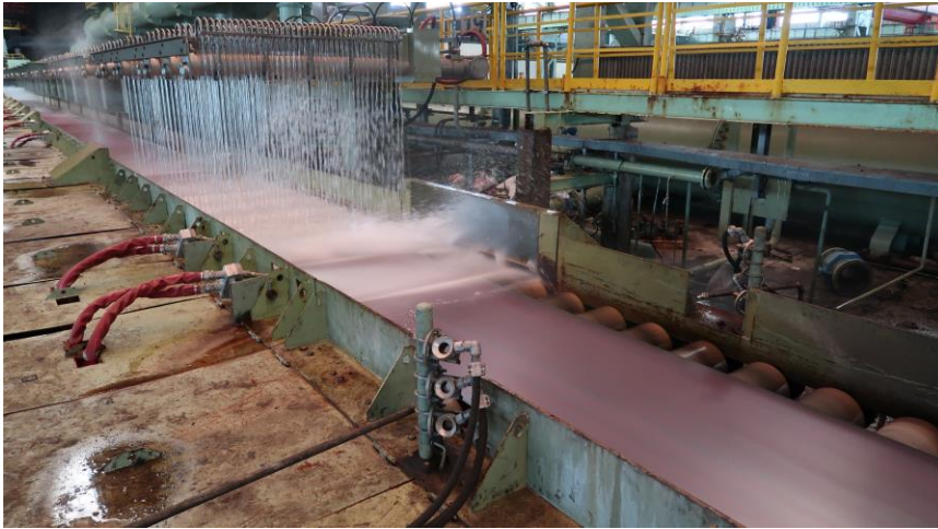
Kühlstrecke im Auslauf der von SMS group modernisierten Warmbandstraße von Ningbo Iron & Steel. Verstärkte Laminarkühlung und Querabspritzung.
