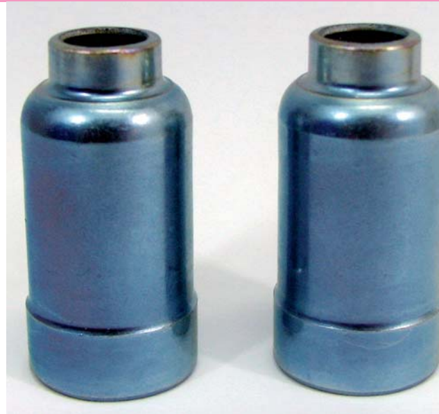
SurTec 716 bildet zusammen mit der Chromitierung® SurTec 680 bläulich-gelbliche Schichten aus
