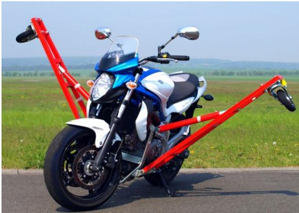
Außerdem vermitteln Fahrübungen auf unserem Schräglagentrainer, einer Suzuki Gladius 650 ABS, wie viel Potenzial im Fahrer und seinem Motorrad steckt. Mit dem Suzuki-Schräglagentrainer lässt sich das Limit beim Motorradfahren auf sichere Weise ertasten.
