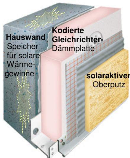
Solarwärme - Speicherprinzip der SOLARDÄMMUNG auf Fassaden:
