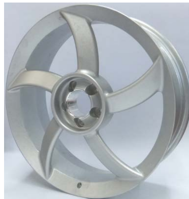
Simulation zur Auslegung der Felgenreometrie (links). Gefertigte Propellerfelge (rechts).
