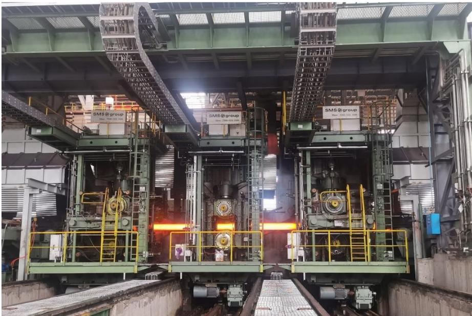
Das Herz der Anlage: die CCS®(Compact Cartridge Stand)-Tandemwalzgruppe mit hydraulischem Anstellsystem und vollautomatischem Programmschnellwechsel.
