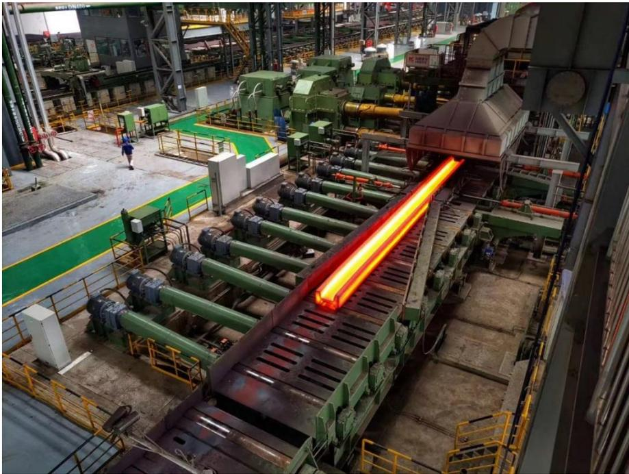
Masteel kann auf der neuen schweren Trägerstraße Abmessungen bis 1.100 Millimeter Steghöhe und 500 Millimeter Flanschbreite herstellen.
