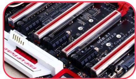
Grafikkarten. Und das Entfernen kann den Stecker erheblich belasten. Die innovative Ausführung des einteiligen Edelstahl-Schilds von GIGABYTE verstärkt die PCIe-Anschlüsse und bietet somit eine zusätzliche Verstärkung, die zur Unterstützung schwerer Grafikkarten erforderlich ist.
