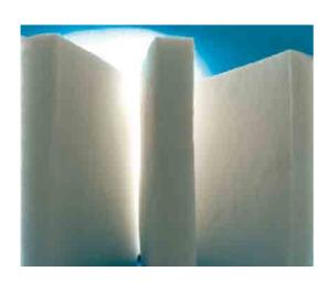
Ein von Piel entwickeltes innovatives Vliesmaterial komplett aus recycelten Polyesterfasern erwies sich mit seinen ausgezeichneten thermischen Eigenschaften sowie zur Geräuschdämmung als ideales Material für den Einsatz im Bausektor. ©Piel S.A.
