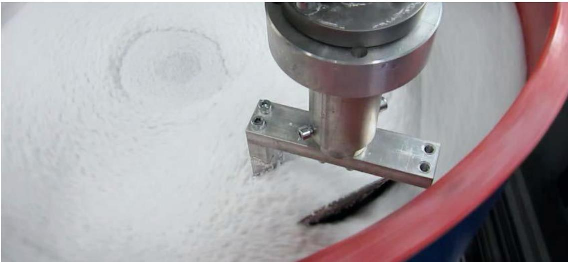
Einspannsituation der Turbinenschaufel während der Bearbeitung
