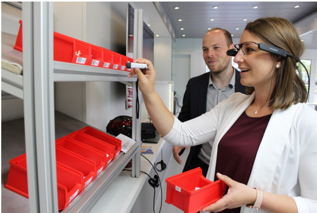
Augmented Reality-Brillen vereinfachen die Kommissionierung © Fraunhofer IGCV
