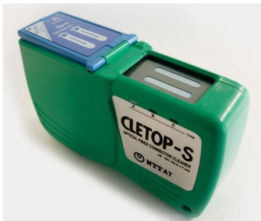
Um den größtmöglichen Reinigungsgrad zu erreichen, wurde die Steckerreinigungsserie CLETOP entwickelt. Die feinen Mikrofasern wischen die Verschmutzungen von der Steckeroberfläche und schließen sie im Gewebe ein. Aufgrund der Reinigungsbandstruktur werden weder Alkohol noch andere Reinigungsmittel benötigt, das macht die Anwendung im Feld sowie im Labor noch einfacher und sicherer.
