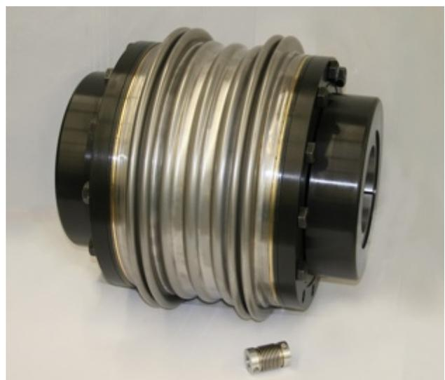
geringen Rückstellkräften auf. Mit hochbelastbaren, aber gleichzeitig sehr flexiblen Edelstahlbälgen arbeiten die Standard-Kupplungen bis zu einem lateralen Versatz von 0,3 mm absolut zuverlässig und dauerhaft. Mit Sonderversionen, z.B. größere Wellenzahl oder größere Baulänge, sind z. T. noch erheblich höhere zulässige Lateralversätze realisierbar.
