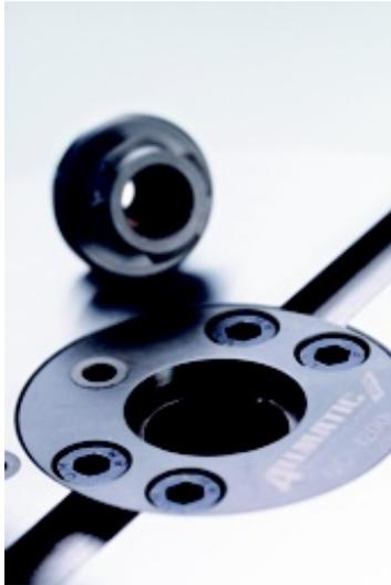
Alle Einzugs- und Spannmechanik ist derart kompakt gestaltet, dass die Spanntöpfe bei einem Durchmesser von nur 70mm bereits ab Tisch- oder Plattendicken von 35 mm bei Erhalt einer glatten Oberfläche integrierbar sind. Sollen in die Tischoberfläche T-Nuten 14 mm eingebracht werden, wird eine Tischdicke von nur 47 mm benötigt.
