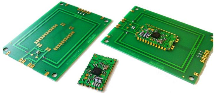
Das neue ‘Reader-Writer’-NFC-Modul vereinfacht die Entwicklung von Anwendungen, für kontaktloses Bezahlen, Karten- & Wertmarkenvertrieb sowie Zugriffs-/Zugangskontrolle. Als NFC-Gateway verwendet, bietet das Modul ein gesichertes ‚Carrier Field‘ durch ID- und Protokoll-Erkennung. Das modulare Konzept ermöglicht verschiedene Designs mit Platinen-Antenne oder externer Antenne.
