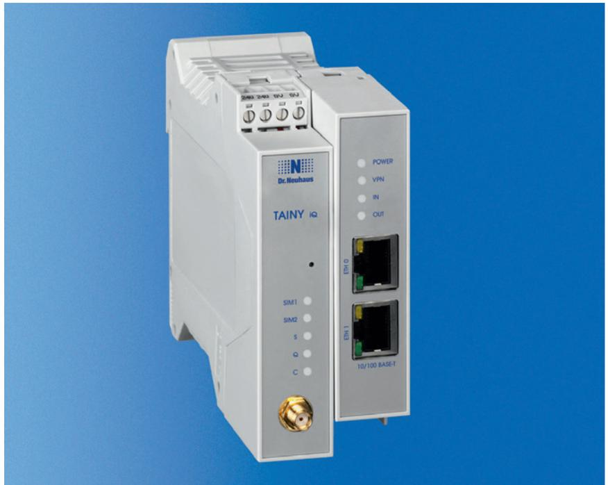
Das TAINY iQ-4GDSE2 von Dr. Neuhaus Telekommunikation kombiniert LTE (4G) Mobilfunk-Modem, VPN (Virtual Private Network) Router mit Zertifikats-Unterstützung und Firewall in einem Gerät. Es ermöglicht den sicheren Versand von hochsensiblen Daten über verschlüsselte Ende zu Ende Verbindungen.
