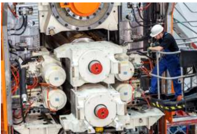
Vormontage eines CVC ® plus-Systems in der SMS group-Werkstatt.
