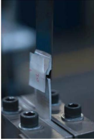
Versagen der Aluminium-Stahl-Proben im Grundwerkstoff.
