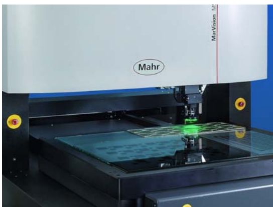
Kombiniert verschiedene Sensoren zur Messung großflächiger Werkstücke: Multisensor-Messplatz „MarVision MS 980“ von Mahr
