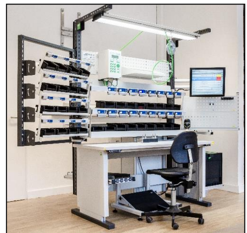
Aufbau und Test eines Einzelarbeitsplatzes vor Auslieferung bei Armbruster Engineering.
