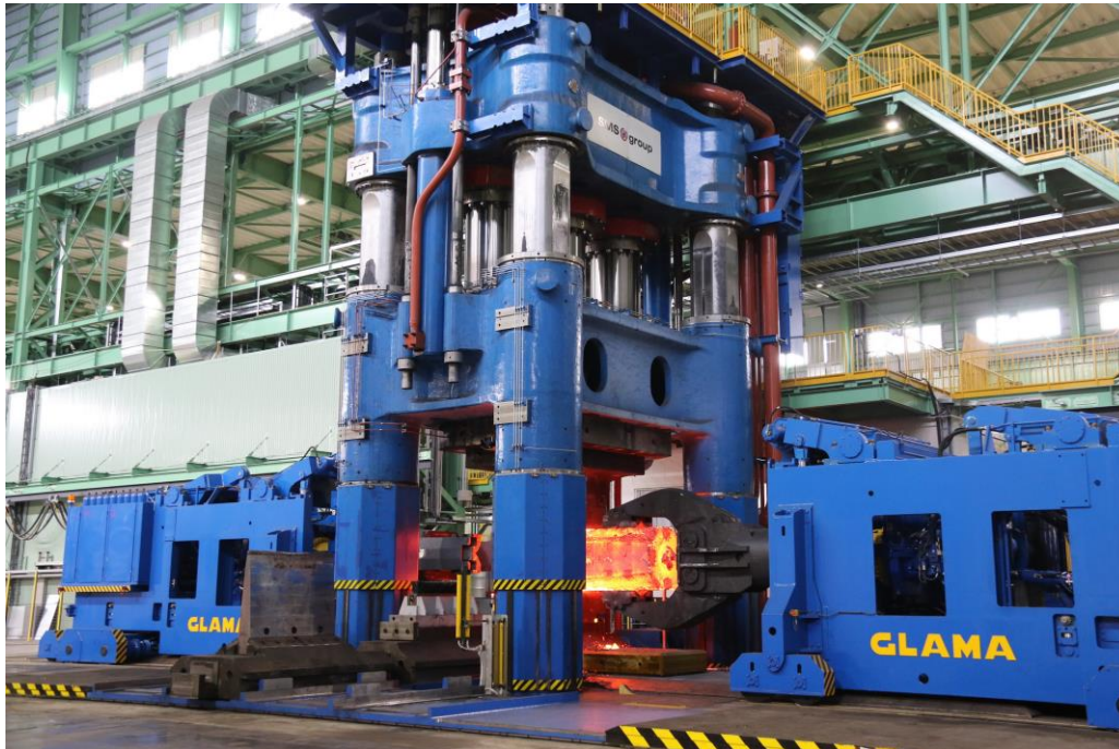
90/108 MN Freiformschmiedepresse in Betrieb im Werk Yasugi.
