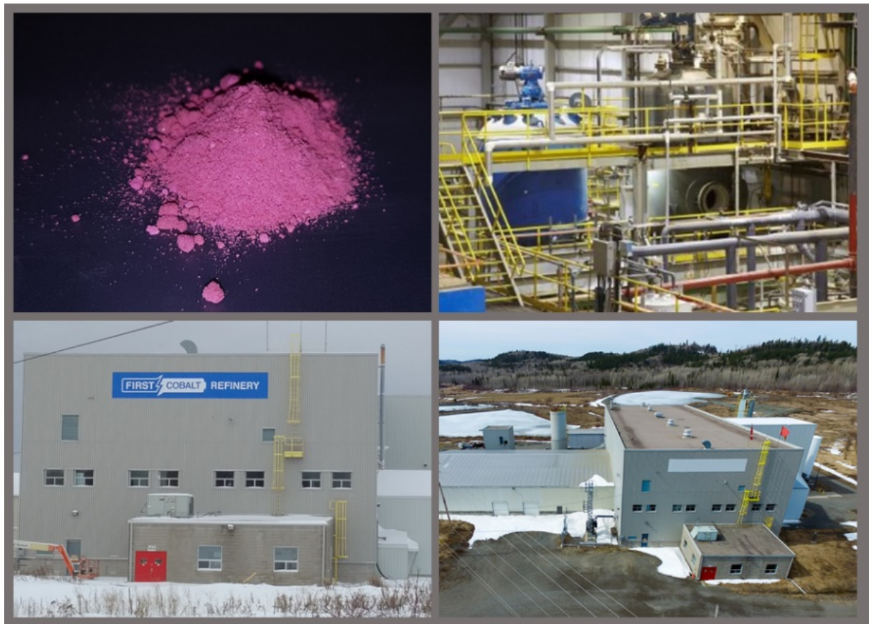
Bild 1. Oben links nach rechts, Kobaltsulfat, hergestellt mit dem Flussdiagramm der First Cobalt Raffinerie; aktueller Autoklavkreislauf. Unten von links nach rechts, Außen- und Flächenbilder der Anlage.
