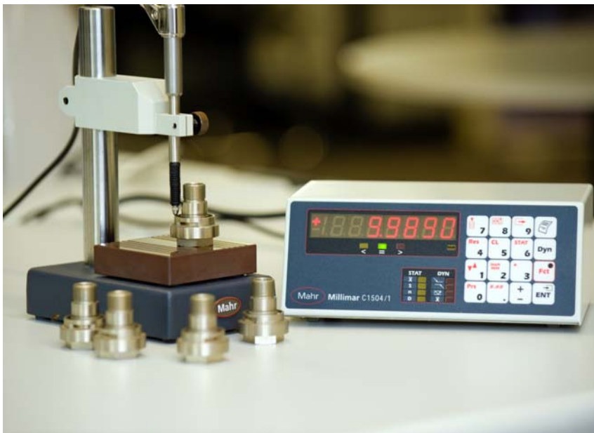
Schnelle und bequeme Längen- und Höhenmessung mit dem „Millimar C1504“ von Mahr.
