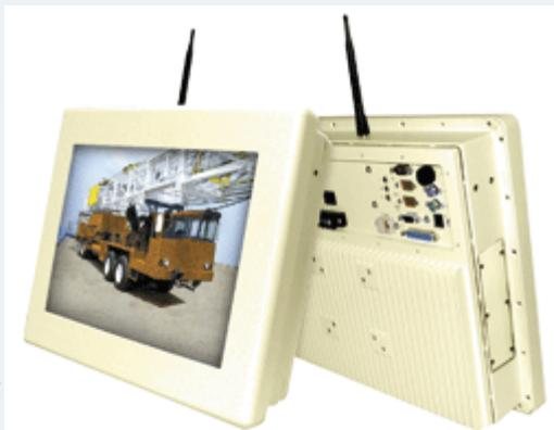
Gleichzeitig liefert er bis zu 87% Lichtdurchlässigkeit und lediglich 6% Lichtreflektion. Ein UL50, Typ 4 ist abgedichtet (wenn richtig eingebaut) und die Zertifizierung für gefährliche Standorte bedeutet, dass der Bildschirm sich in rauen Umgebungen selbst übertrifft.
