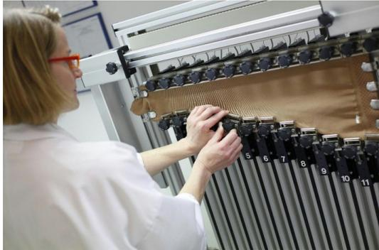
Mit dem selbst entwickelten Messgerät HOSY der Hohenstein Institute wird die Kompressionswirkung sowie der Kompressionsverlauf eine Prüfmusters bestimmt. 20 nebeneinander liegende Zugprüfeinrichtungen testen den komprimierenden Effekt. © Hohenstein Institute
