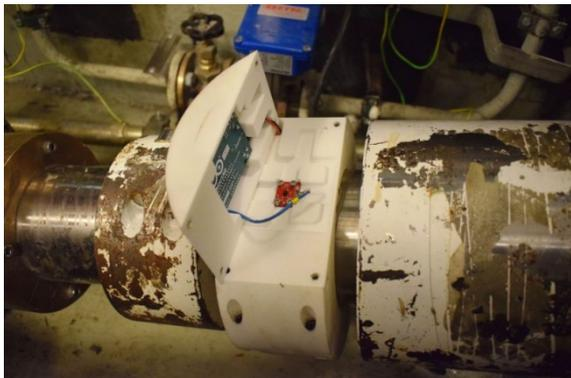
Einbau des Sensors im Schiffsantrieb.
