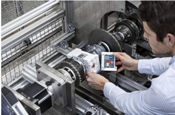
Auf der Antriebswelle eines Zweitaktmotors angebrachter Beschleunigungssensor mit Elektronik zur Datenverarbeitung und drahtloser Echtzeit-Datenübertragung.
