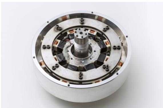
Energy Harvester zur Wandlung von mechanischer Schwingungsenergie in elektrische Energie. Foto: Raapke/Fraunhofer LBF
