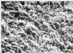
mit 2,5 ml/l SurTec 312, j = 140 \text{ A/dm}^2 , v = 70 \text{ m/min}
