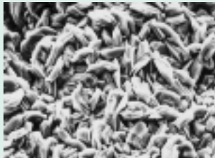
mit 7 ml/l SurTec 307 I, 3 ml/l SurTec 307 II, j = 140 \text{ A/dm}^2 , v = 70 \text{ m/min}
