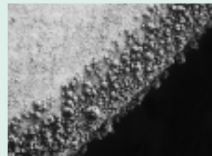
aus Chloridelektrolyt ohne Additiv, j = 200 \text{ A/dm}^2 , v = 70 \text{ m/min}
