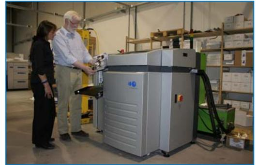
*Die Station fastBook von Imaging Solutions zur automatischen Herstellung von Buchblöcken mit Leporello-Bindung für optimale Planlage*
