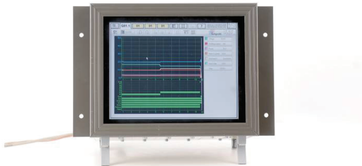
Bild 2: Q84-Schweißdatenvisualisierung zur schnellen Parameterfindung
