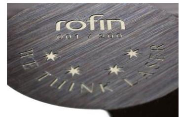
Abb. 3: mit dem StarFemto tiefengravierter Uhrendeckel
