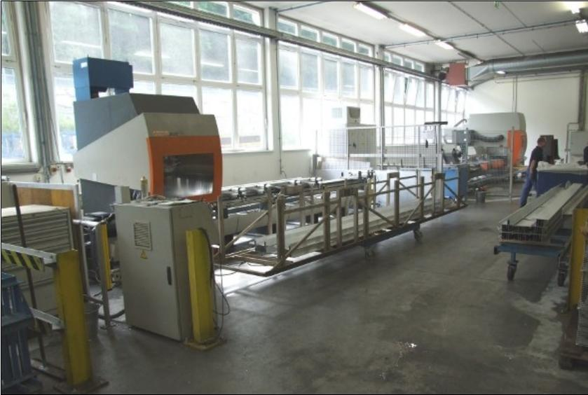
Die Kombination elumatec-Stubbearbeitungszentrum und Programmiersoftware PUMA-System<sup>®</sup> hat sich bei Neuman bewährt. Ein 3-Achs-Zentrum SBZ 130 und drei 5-Achs-Maschinen SBZ 151 werden mittlerweile zur präzisen Bearbeitung der Profile eingesetzt.
