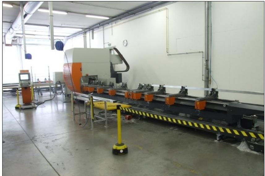
Das SBZ 151 bietet einerseits die Möglichkeit zur Langteilmbearbeitung, andererseits kann auch im Pendelbetrieb gearbeitet werden. Zwei mitfahrende Werkzeugmagazine sorgen für kurze Bearbeitungszyklen.
