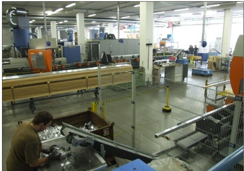
Zum Maschinenpark im Strangpresswerk gehören 5 Stabbearbeitungsmaschinen. Die Programmiersoftware PUMA-System<sup>®</sup> ermöglicht es, das Bearbeitungsprogramm an eine beliebige Zielmaschine zu schicken.
