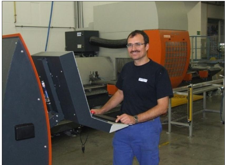
Roland Edelbauer, Vorarbeiter in der Abteilung Profilbearbeitung bei Neuman Aluminium, am Bedienpult einer SBZ 151. Das Stabbearbeitungszentrum erlaubt mit Winkelkopf die 6-seitige Profilbearbeitung in einer Aufspannung am ruhenden Profil.
