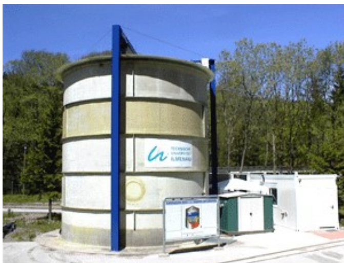
Ilmenauer Fass - Großgerät zur Untersuchung turbulenter Konvektionsströmungen
