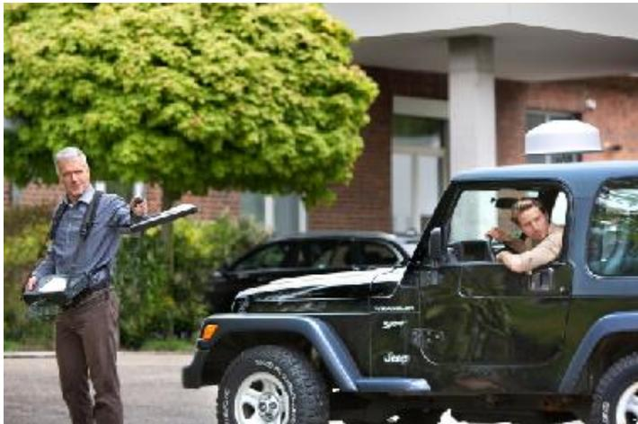
**Immagine 1: Per l'impiego mobile l'ADFA 2 viene fissata sul tetto di un'autovettura con l'ausilio di un supporto magnetico e collegata con il SignalShark all'interno del veicolo. Se il tecnico deve entrare in un edificio localizzato per determinare la sorgente del segnale lungo gli ultimi metri, userà un'antenna portatile per completare l'operazione di direction finding.**
