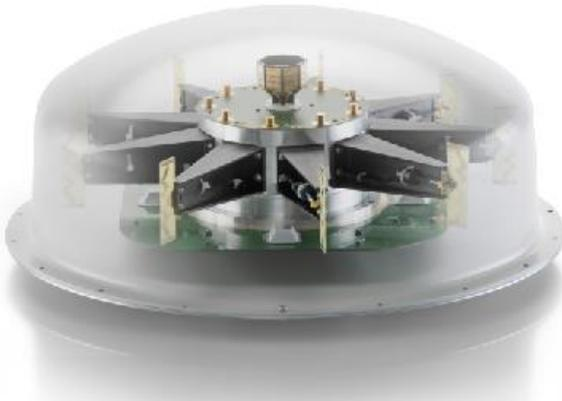
**Immagine 2: Il cuore dell'ADFA 2 è costituito da un livello con nove elementi (dipoli) e da un'antenna di riferimento omnidirezionale centrale. Dall'espansione di frequenza alle due estremità della scala, risulta ora un livello inferiore per la gamma da 10 a 200 MHz e un livello superiore per la gamma da 2,7 a 8 GHz.**
