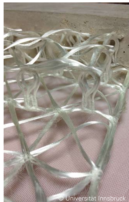
Dreidimensionale Stickerei aus Glasfaserkabel als Verstärkungsstruktur
