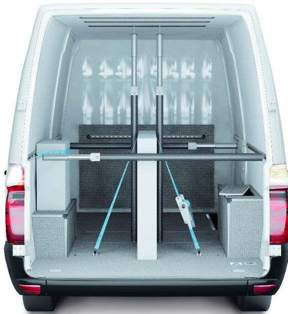
Abbildung 1 VANyCARE ® -Komplettausstattung incl. Ladungssicherungssystem mit Sperrstange, Zurrschienen und Gurten
