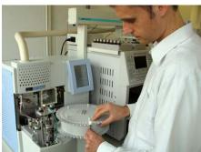
Qualitativer und quantitativer Nachweis von Geruchssubstanzen auf Werkstoffen und Textilien mittels Gaschromatograph mit Massenspektrometer.
