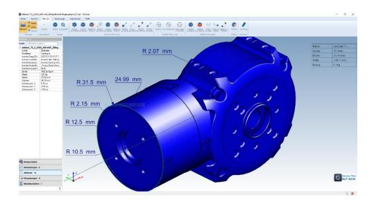
Glovius zeigt Einzelteile und Baugruppen der verschiedenen Formate an. Schnappschüsse der Modelle können ausgedruckt und per E-Mail versendet werden. Die Modelle können vermaßt, geschnitten und verglichen werden. Ein besonderes Highlight ist die Möglichkeit, Modelle und Baugruppen im 3D HTML-Format abzuspeichern. Diese Dateien können anschließend in einem beliebigen Browser – ohne zusätzlich benötigte Software! – betrachtet werden.
