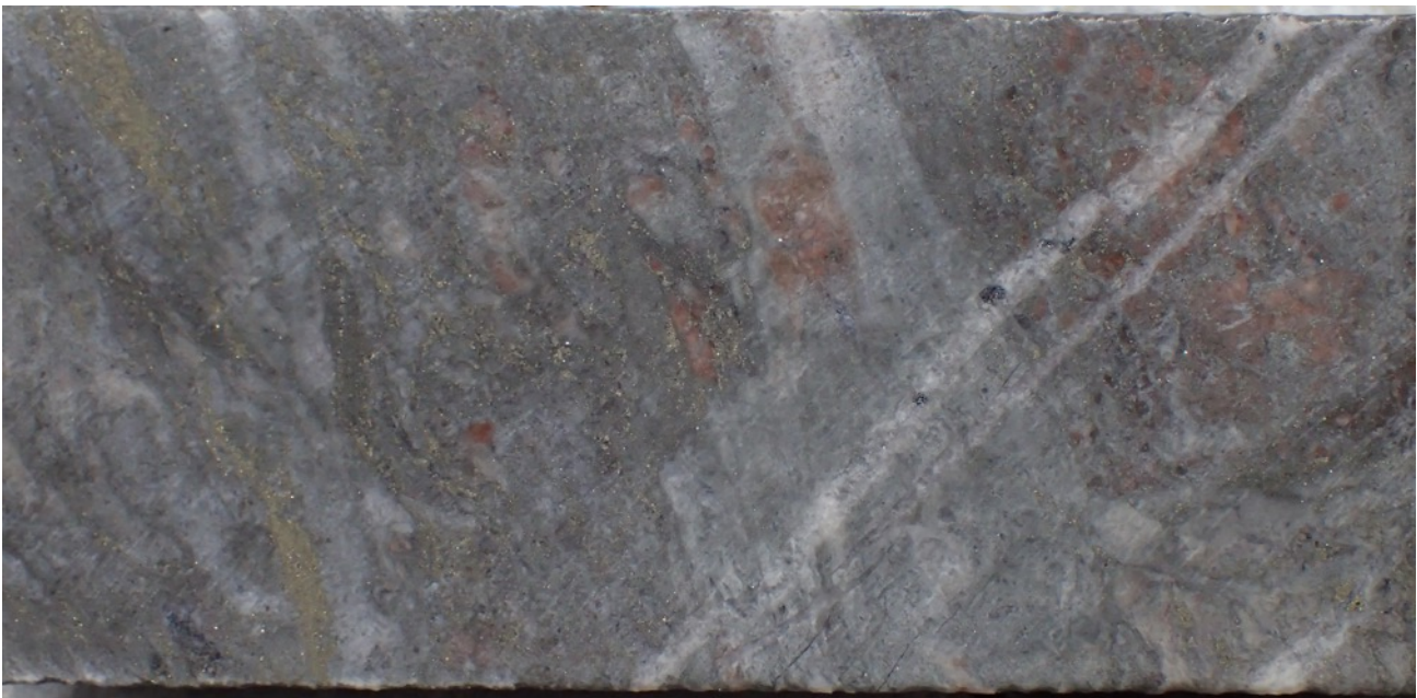
Abbildung 2: Probe von stark veränderten und pyritisierendem Basalt mit Syenitfragmenten im Intervall von 9,74 g/t Au; Sichtfeld 47,6 mm.
