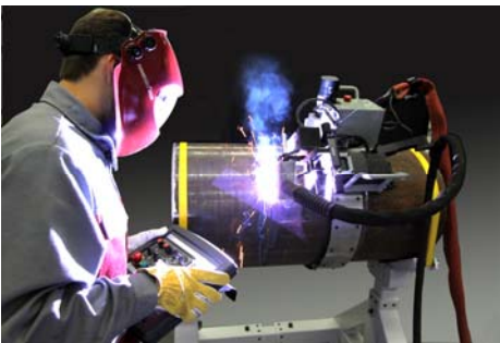
Abb.4: Automatisiertes MAG-Schweißen in WIG-Qualität: Die serienmäßige Fernsteuerung gibt dem Bediener die Möglichkeit, den orbitalen Fügeprozess vollständig zu beobachten und, wenn nötig, korrigierend einzugreifen Foto: EWM HIGHTEC WELDING
