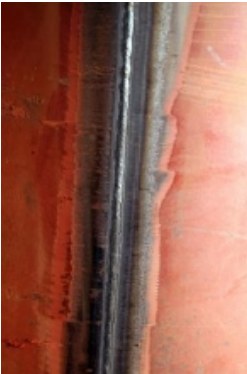
Abb.5: pipeSolution ® , das automatisierte MAG-Verfahren zum Wurzelschweißen: bis zu 5-fache höhere Schweißgeschwindigkeit gegenüber manuellem WIG-Schweißen, 100 Prozent röntgensichere Naht Foto: EWM HIGHTEC WELDING
