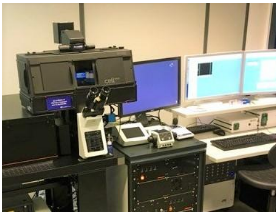
Das kombinierte STED-AFM-System der Lafont Gruppe mit dem integrierten JPK NanoWizard® Rasterkraftmikroskop.
