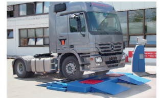
Bremsprüfung an einem Nutzfahrzeug auf dem MAHA-Rollensatz IW 7
